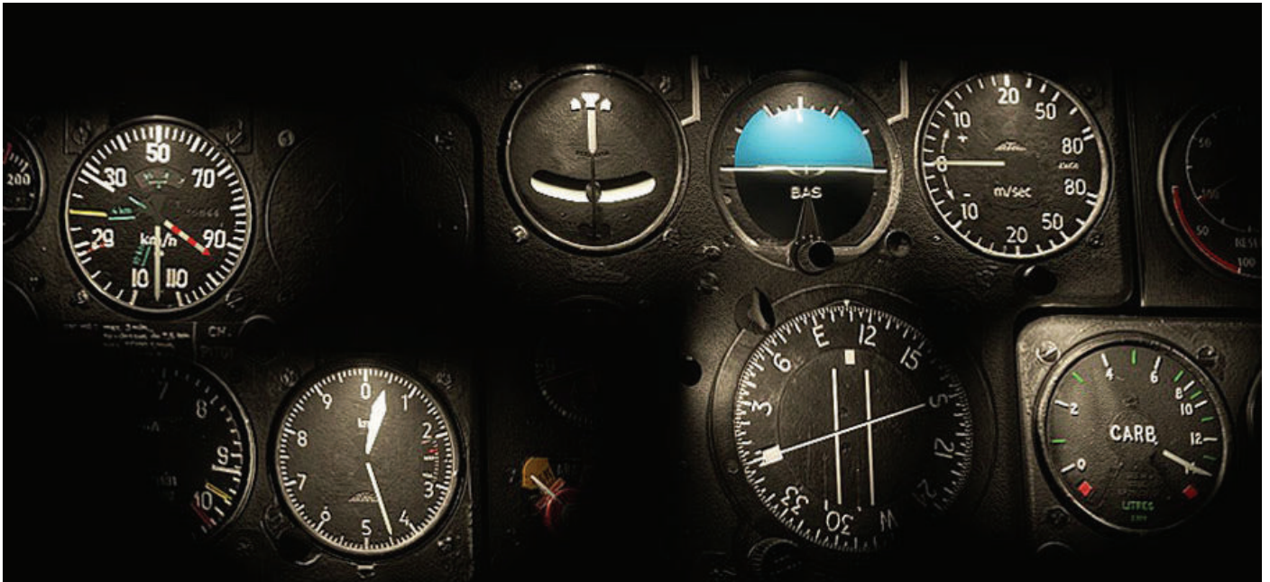
Eclairage normal des instruments par lampe sur le côté de l'instrument
