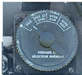
Choix du type de projection du viseur Fixe/Fixe et gyro/ Gyro jour/Gyro nuit +réglage d'intensité
