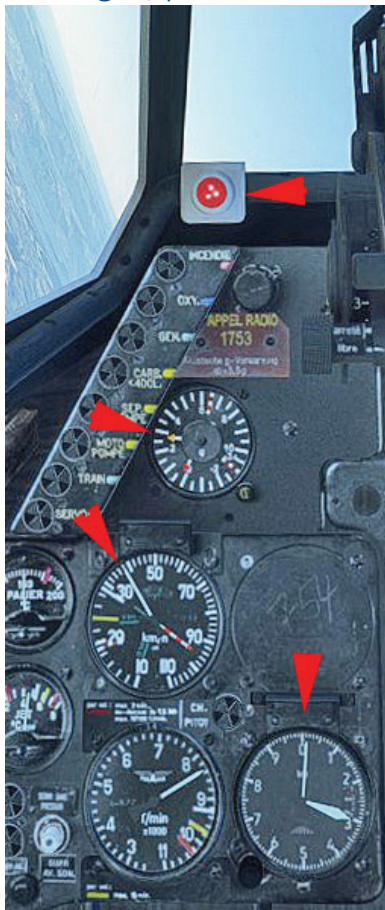
Annonce de décrochage à vitesse réduite à 380km/h et avec +3 g.
